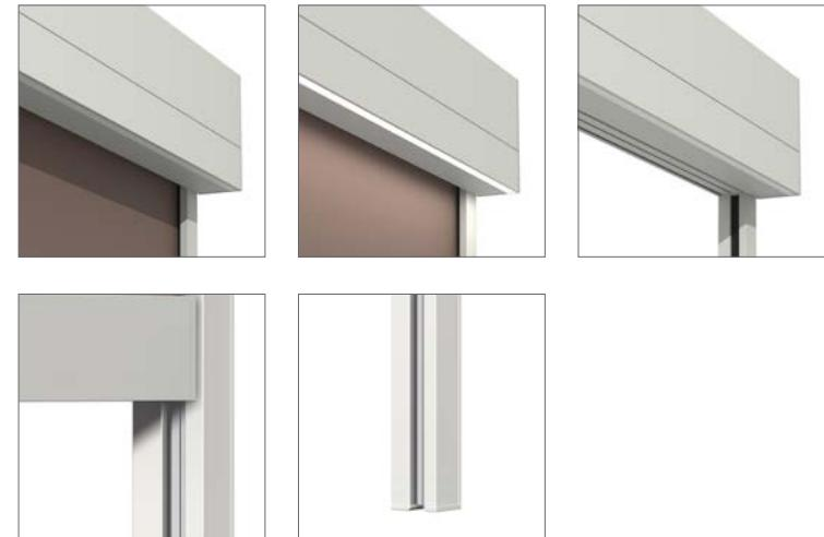
**IT** Tenda con cassonetto da 110mm con terminale a scomparsa, dotata di sistema di guida ZIP e cassonetto autoportante. Adatta per installazioni su infissi, sia a nicchia che a parete; veloce ed agevole da installare ed ispezionare. La guida è composta da due profili: supporto e copertina; è sviluppata per i soli sistemi motorizzati riducendo la larghezza a 36 mm.
