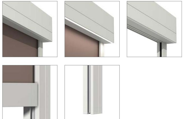
**IT** Tenda con cassonetto da 110mm con terminale a scomparsa, dotata di sistema di guida ZIP e cassonetto autoportante. Adatta per installazioni su infissi, sia a nicchia che a parete; veloce ed agevole da installare ed ispezionare. La guida è composta da due profili: supporto e copertina; è sviluppata per sistemi sia ad argano che motorizzati.
