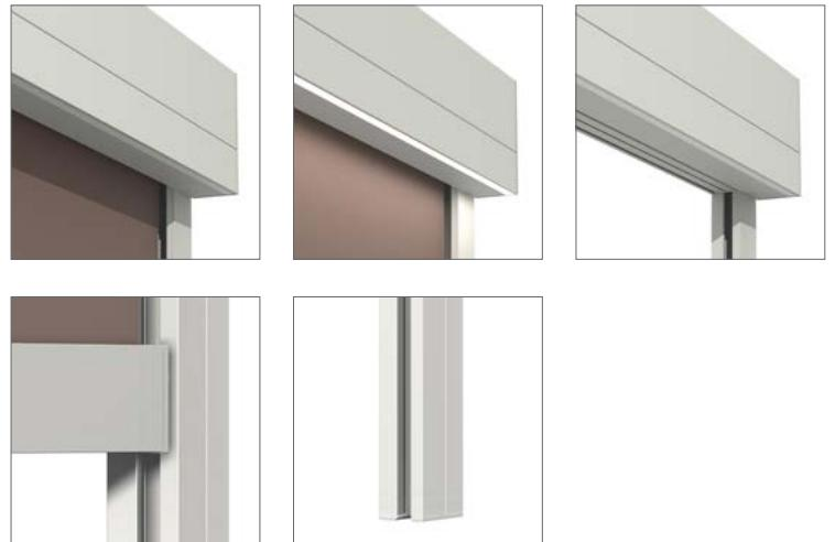
**IT** Tenda con cassonetto da 110mm con terminale a scomparsa, dotata di sistema di guida libera e cassonetto autoportante. Adatta per installazioni su infissi, sia a nicchia che a parete; veloce ed agevole da installare ed ispezionare. La guida è composta da due profili: supporto e copertina; è sviluppata per sistemi sia ad argano che motorizzati.
