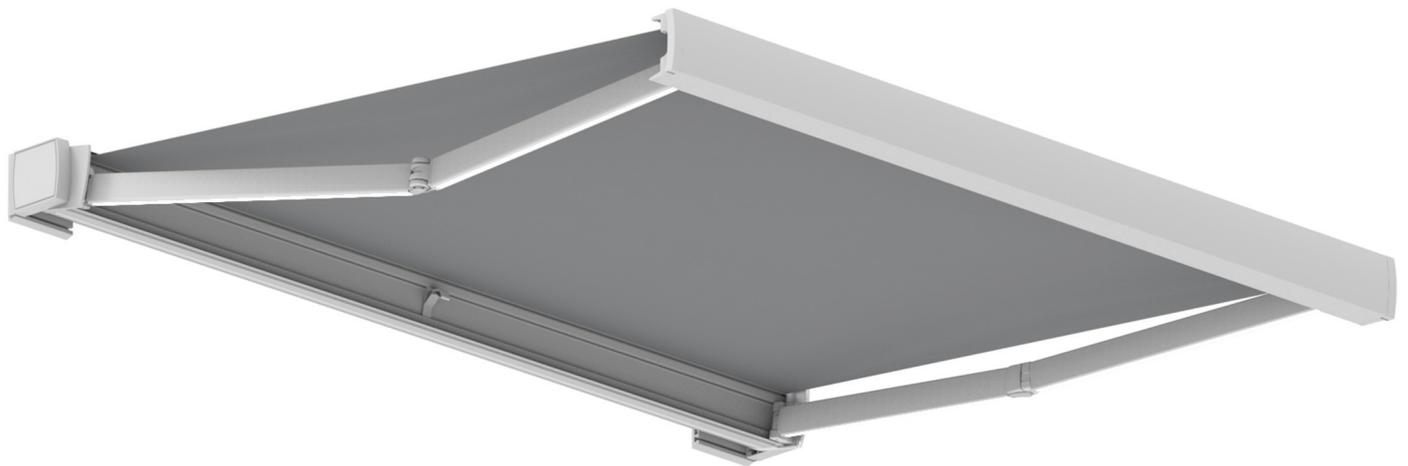
EPICA LITE est un store coffre avec bras extensibles qui est fixé sur deux supports latéraux avec une contre-plaque de fixation et bras Balteus. Le coffre, avec accès simple et facile, est fourni en trois profils séparés. Les supports peuvent être montés au mur ou au plafond et le réglage peut être fait d'une seule fois, grâce au système vis passante.
